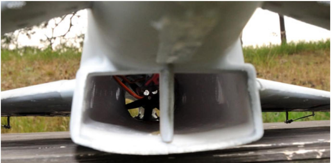
Leider lassen sich nur sehr kleine Regler in den vorgesehenen Platz unterbringen. So haben wir unseren Regler entgegen der Bauanleitung nicht unterhalb der Seitenflosse sondern oben im Impellerkanal (vor dem Impeller) anbracht und er ist damit optimal gekühlt. Mehr gibt es zum Bauaufwand auch schon nicht zu sagen.
