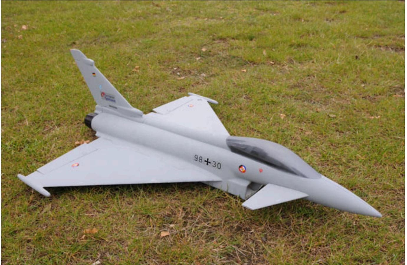
Das Modell wurde in Deutschland auch von Graupner vertrieben, welches mit der SAPAC RTF-Version identisch ist. Das Modell muss lediglich mit Empfänger und Regler ausgestattet werden und die Flächen, das Seitenleitwerk und die Canards sind anzukleben. Weiter muss die Kabinenhaube verklebt werden. Drei Servos sowie der Motor und der Impeller sind bereits eingebaut. Das Modell verdient also den Namen RTF schon mal zu recht denn in zwei Stunden ist es flugbereit.
