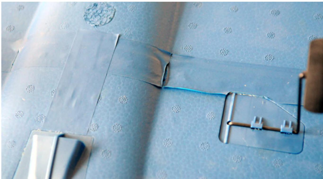
Das Hauptfahrwerk muss lediglich in die bereits eingebaute Fahrwerksaufnahme aus Plastik eingesetzt werden.
