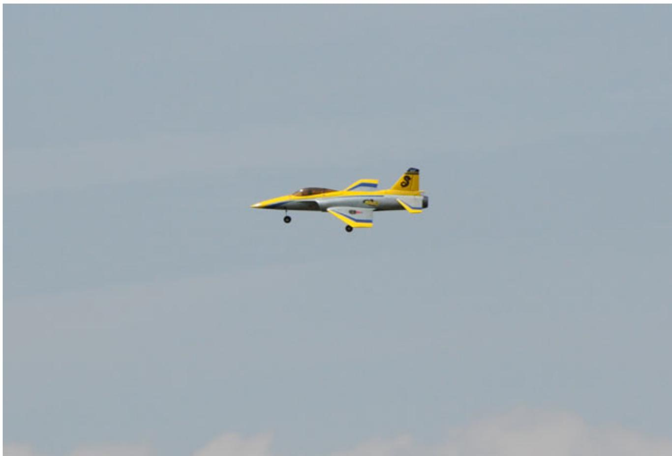
Auch ohne Fahrwerk lässt sich der Habu leicht aus der Hand starten. Mit etwas Höhentrimmung und einem beherzigtem Wurf aus dem Stand kann man den Habu ebenfalls problemlos in die Luft befördern. Wenn man etwas geübt ist, dann kann man auch auf einen Helfer beim Werfen verzichten.
