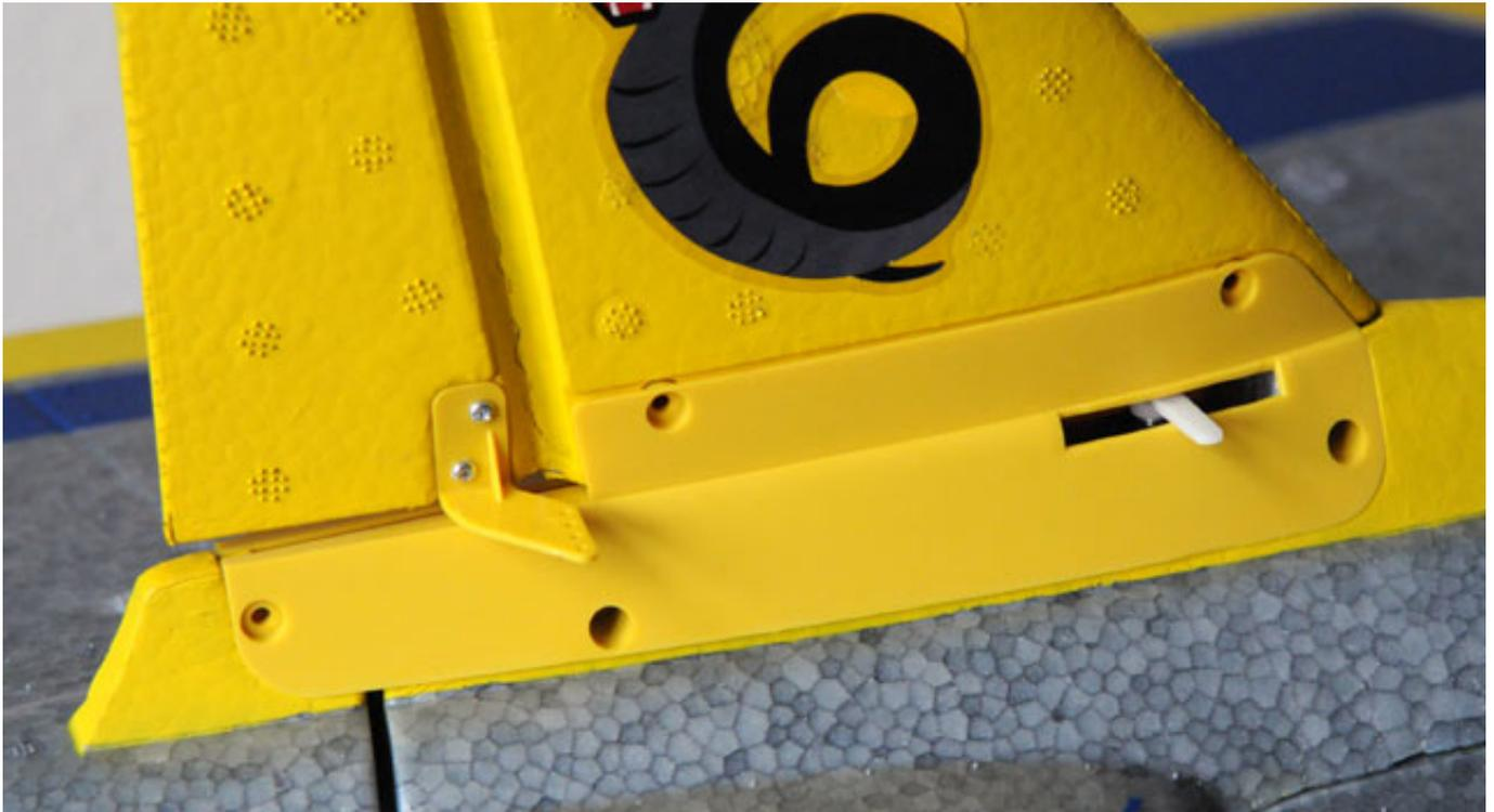
Nach der Verschraubung setzt man nur noch die Anlenkung ein. Die beiden Querruderservos lassen sich auf Wunsch auch von einem Servokanal aus ansteuern. Ein entsprechendes V-Kabel liegt dem Bausatz bei. Die Servo-Querruderkerbel sind auch entsprechend beschriftet.
