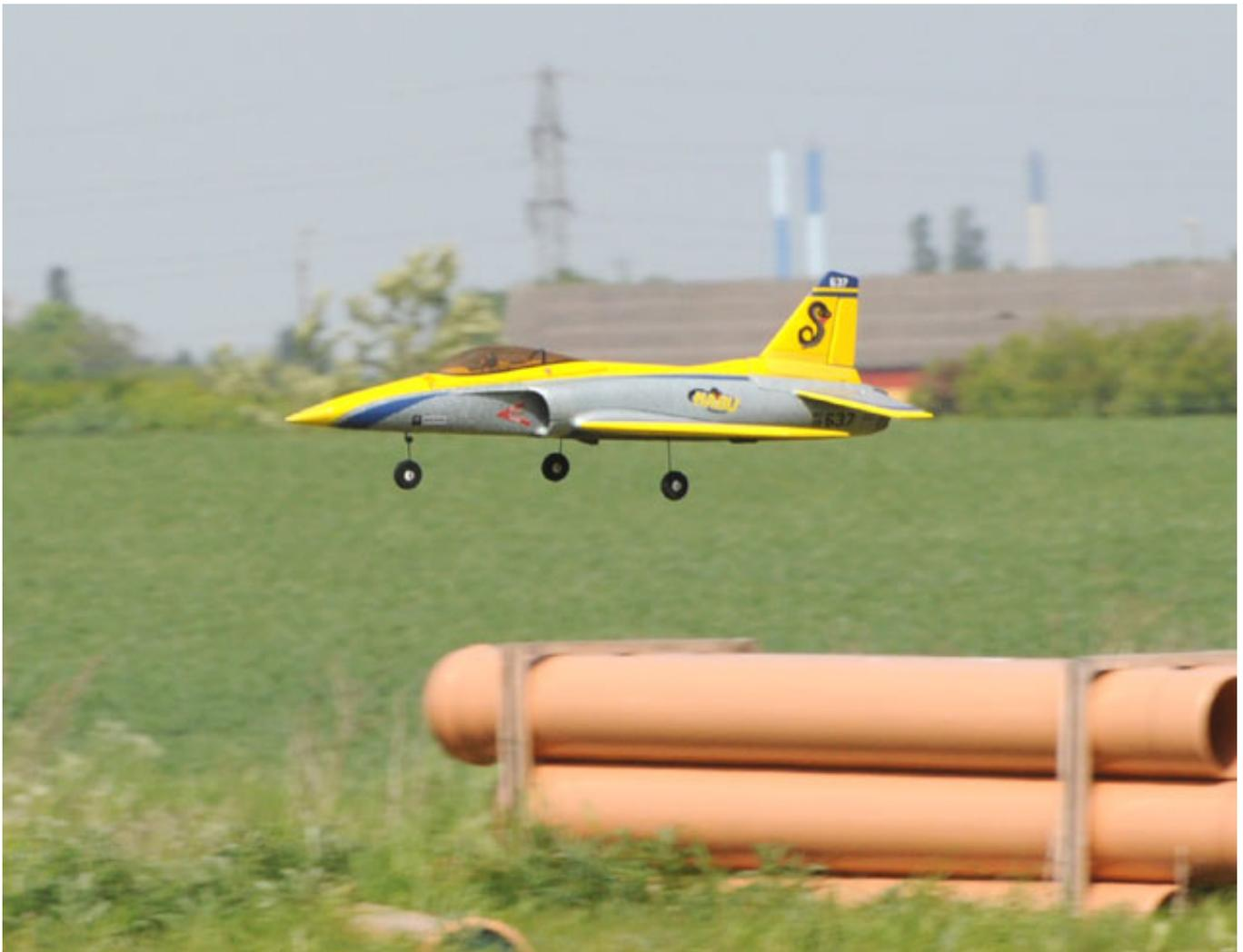
Wir haben die kleinen Ruderausschläge aus der Anleitung eingestellt und diese passen auch gut. Es ist auch keine erwähnenswerte Trimmung nach dem Erstflug erforderlich gewesen. Mit Fahrwerk erreicht er über 120 km/h und ohne Fahrwerk sind es ca. 130 bis 140 km/h. Er lässt sich somit für seine Größe sehr Jet-like fliegen. Rollen und Messerflug sowie sonstige Kunstflugfiguren gehen problemlos.
