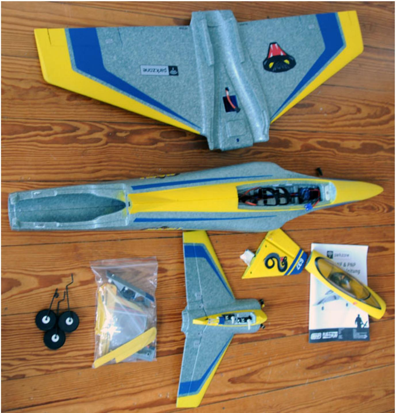
Zum Zusammenbau ist kein Kleben erforderlich. Die Komponenten werden alle entweder zusammengesteckt oder geschraubt. Ggf. muss noch der Stecker für den Akku auf das verwendete Stecksystem geändert werden. Das ist aber auch schon die einzige Lötarbeit die durchzuführen ist. Die Zusammenbauzeit beträgt ca. eine halbe Stunde und vielleicht noch eine viertel Stunde die Fernsteuerung konfigurieren und es kann geflogen werden.
