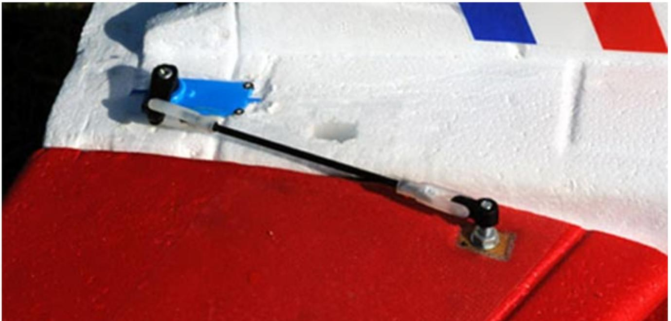
Auffällig ist die hintere Ruderanlenkung. Diese ist mechanisch alles andere als optimal aber sie funktioniert in der Praxis. Der Flügel ist übrigens abnehmbar (einteilig). Das Hauptfahrwerk ist auch im Flügel verbaut. Man benötigt daher eine Schnellkupplung für die Pneumatik des Hautfahrwerks.
