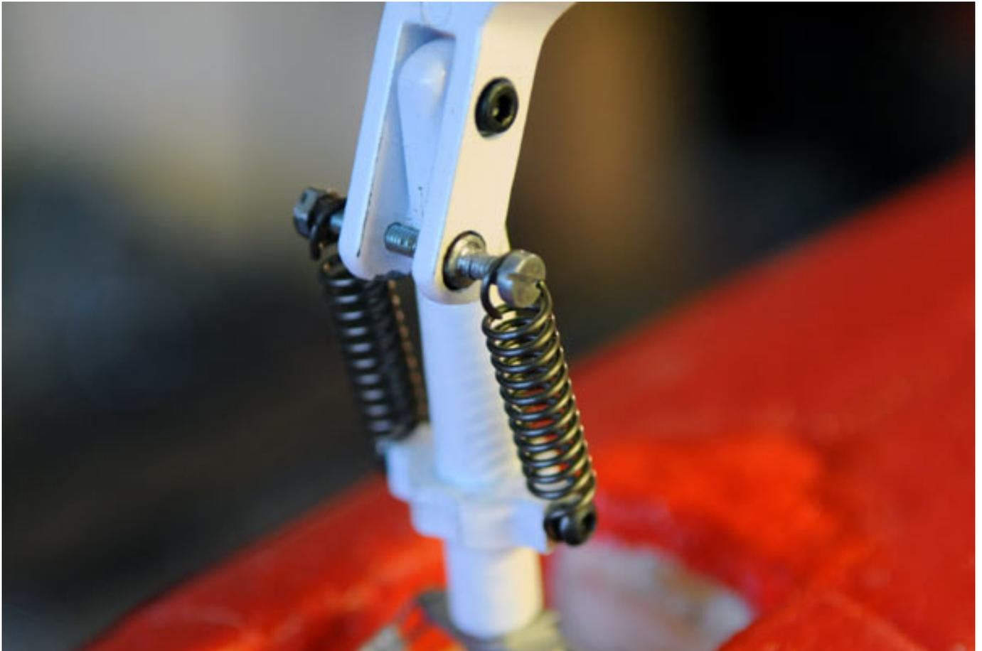
Viele Modellbauer verwenden die FlyFly-Alubeine mit einem neuen Fahrwerk weiter. Es passen aber auch die preiswerten und in der Qualität deutlich besseren Eurokit-Beine (Druckguss) sehr gut in das Modell und damit ist dann das Problemthema Fahrwerk passé. Man muss hier aus mechanischen Gründen statt der einen zentralen Feder zwei Federn an den beiden Seite vorsehen. Eine Modifikation ist aber schnell realisiert (s. oben).
