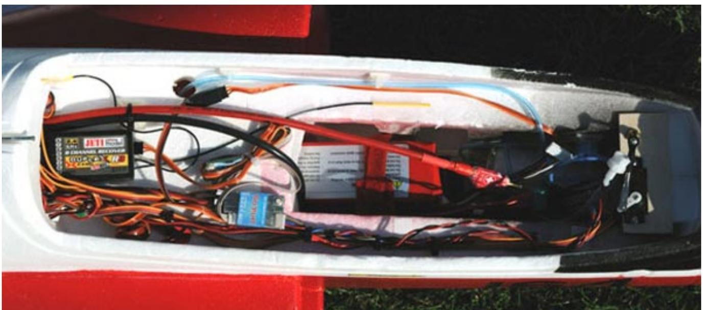
Neben einem [SM-Modellbau](#) UniLog mit Staurohr und diversen Sensoren, haben wir das Modell mit zwei Kollisionsblitzern (weiss, 1 W Luxon-Emitter) auf Rumpf und Unterseite sowie einem 20-mm-Landescheinwerfer (3 W Luxon-Emitter) und [OPTOTRONIX](#) ACL ProControl ausgestattet. Als Spannungsquelle für die Beleuchtung dient ein kleiner Lipo-Akku. Wenn man das alles nicht einbaut, lassen sich fast 300 g an Gewicht sparen. Uns war es das aber wert.
