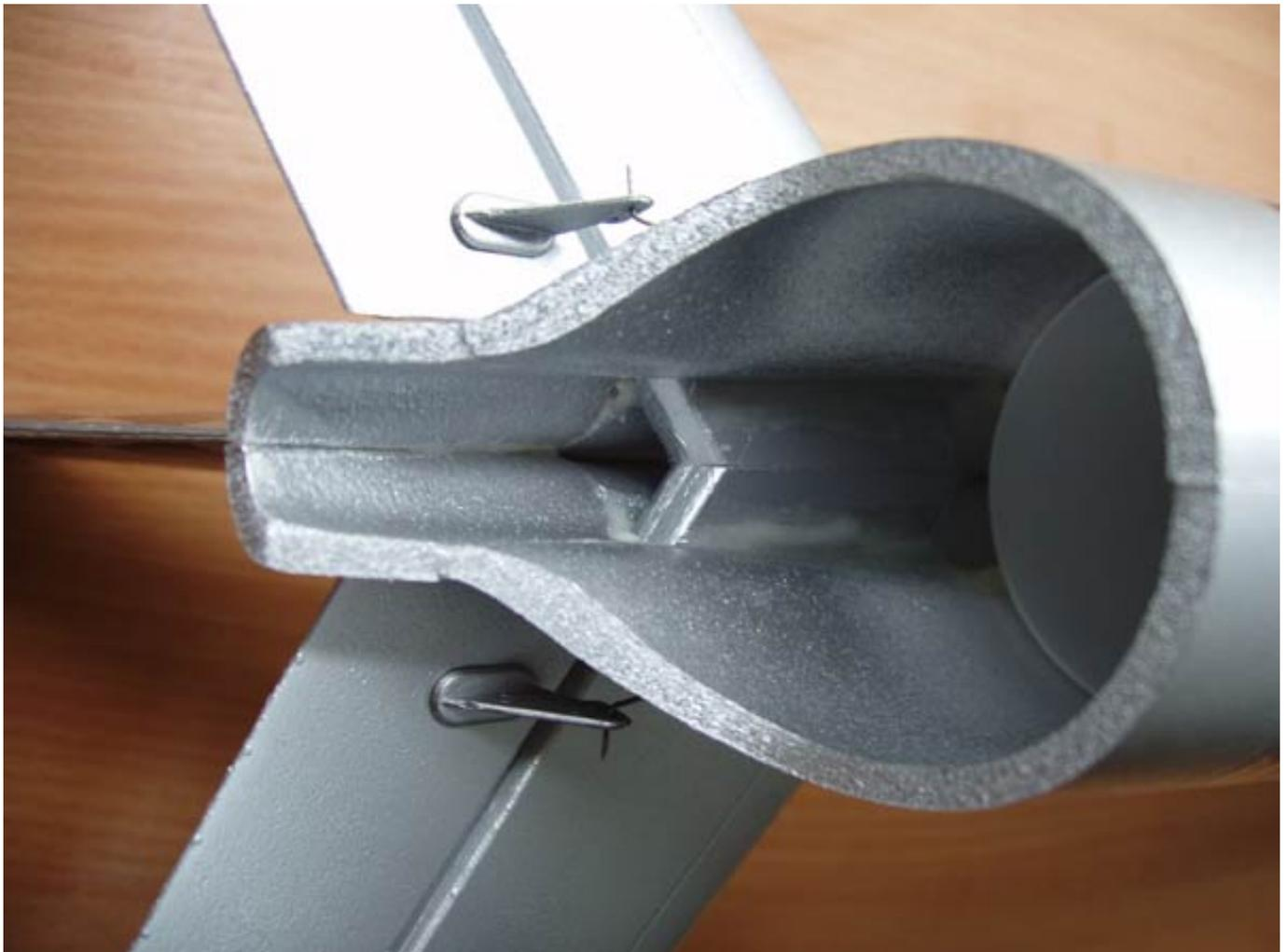
Der größte Bauaufwand ist das Einbauen des Impellers und des Luftkanals. Die Luftzuführung ist aus Pappe und mit ein paar Kunststofffolien oder Tiefziehteile hätte man es dem Modellbauer einfacher machen können.
