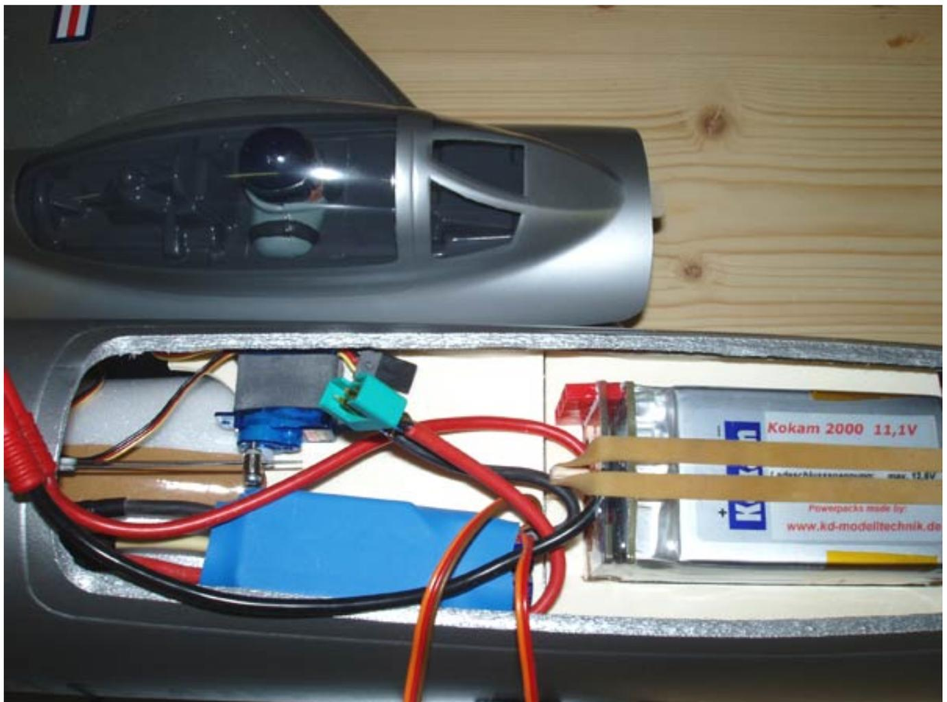
Der Ausbau unter dem Cockpit sollte unbedingt mit Holz verstärkt werden. Hier sind auch Regler und der Akku untergebracht.
